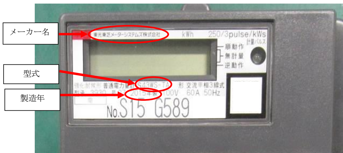
故障が発生したスマートメーターの外観 (外観上の異常は見られない)
