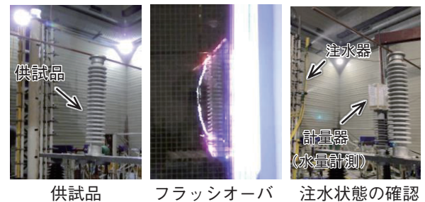
図4 商用周波注水耐電圧・雷インパルス耐電圧試験
