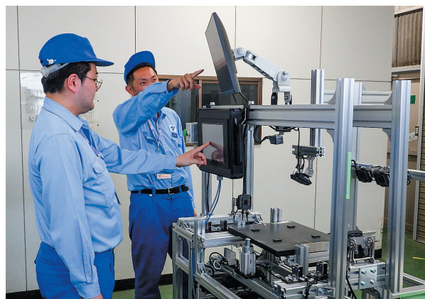
図2 画像センサー5台による自動外観検査装置
