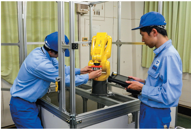
図 3 ロボットによる部品配膳自動化検証
