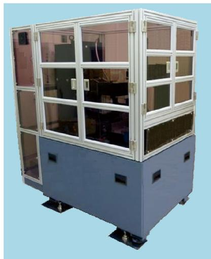
図5 膜厚検査装置
