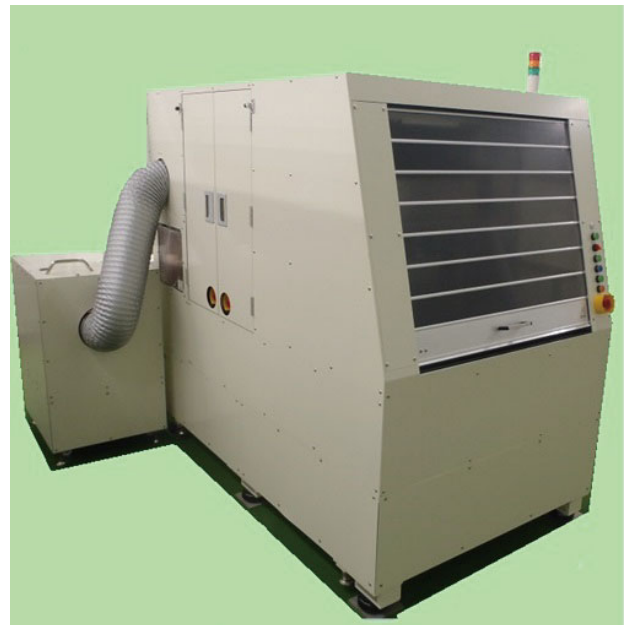
図3 温度可変基板反り検査装置の外観
