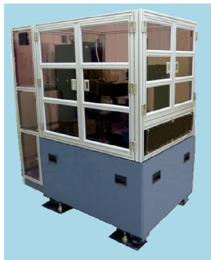
図5 膜厚検査装置
