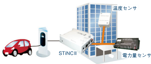
図9 デマンドコントロール構成例
