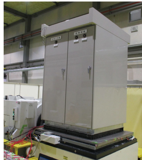
図6 耐震試験状況
