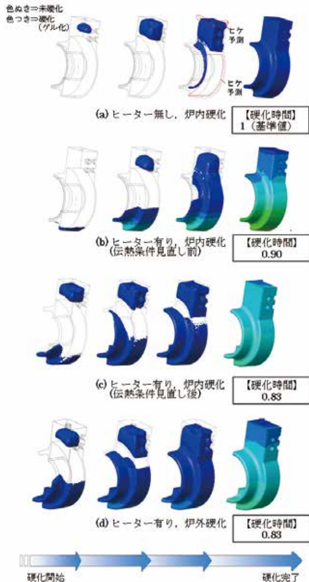
図4 硬化解析による硬化順序の把握
