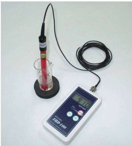
図1 溶存水素計THD-100の外観
