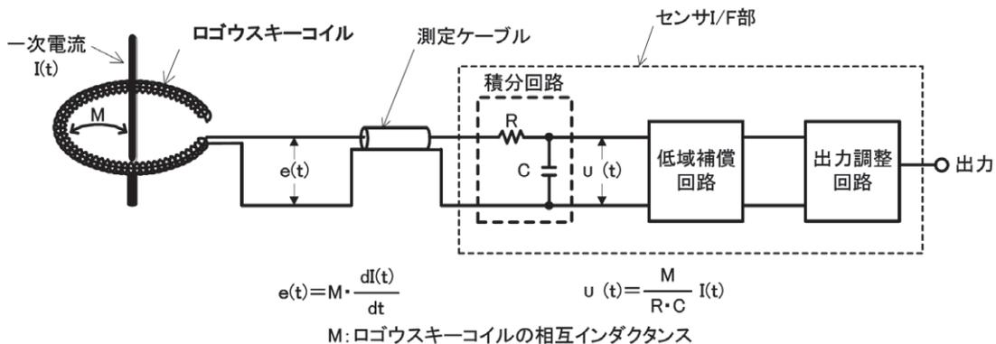
図1 ログウスキーコイルの計測原理
