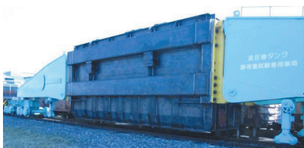
図2 荷重試験モデルタンク（試験車両への積載状況）
