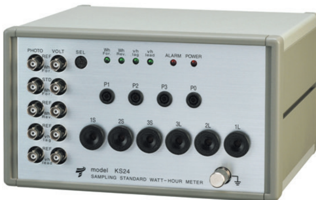
図 4 デジタル・サンプリング方式 KS24 形標準電力量計
