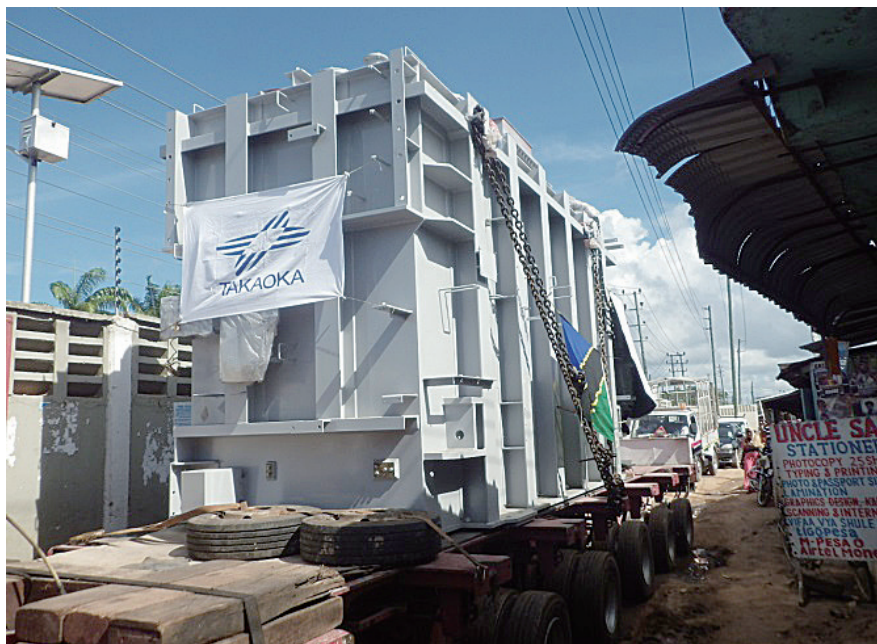
ダルエス港から ILALA 変電所前に到着した 60 MVA 変圧器
