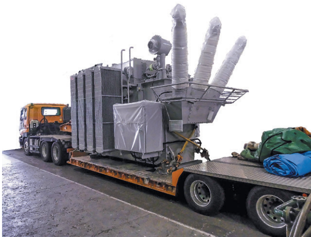
図3 窒素密封式変圧器油入全装輸送
