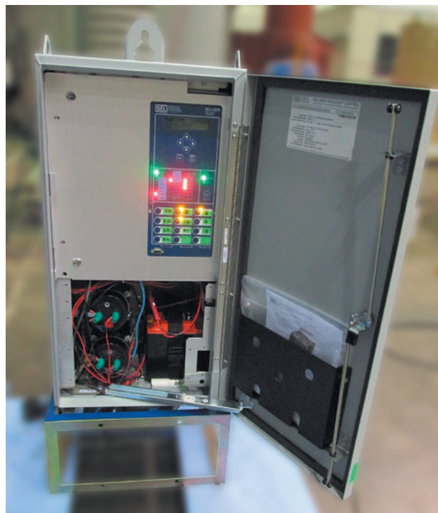
図5 IED を活用した制御器の外観
