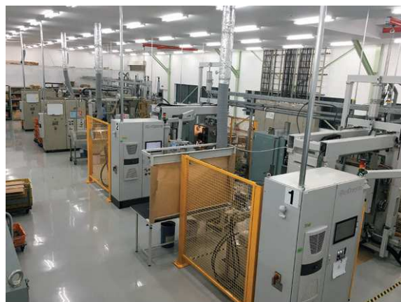
図2 自動加圧ゲル化法注型ライン
