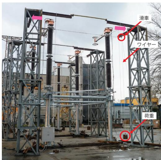
図 6 端子荷重試験設置状況
