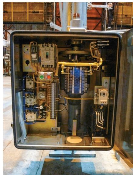
図 2 製品化した電動操作装置
