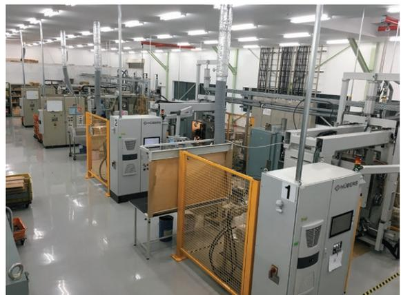
図2 自動加圧ゲル化法注型ライン
