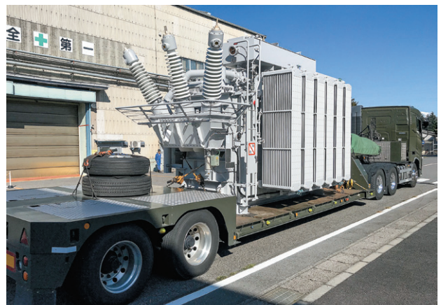
図 3 配電用変圧器油入全装輸送
