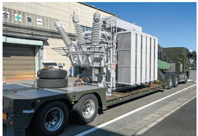
図 3 配電用変圧器油入全装輸送
