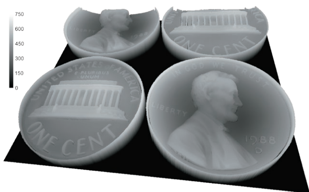
図6 1セントコインの計測
