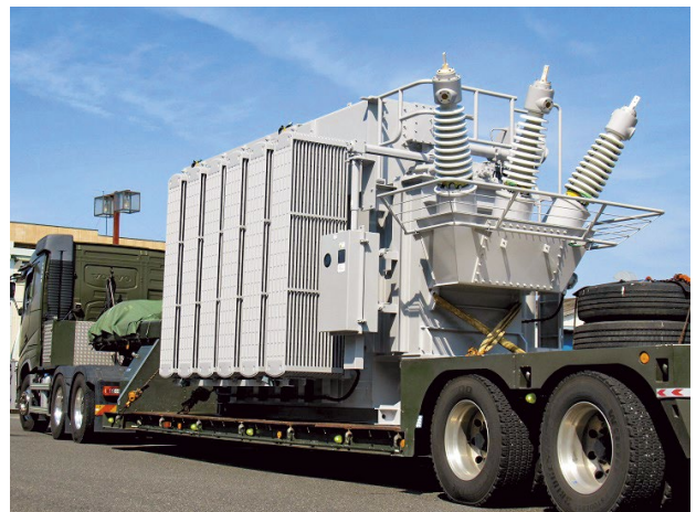
図 2 トレーラ積載状態
