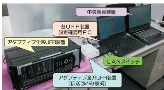
図 3 検証試験状況
