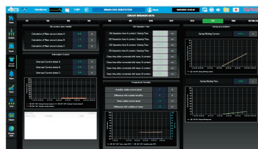
図8 遮断器設備診断画面
