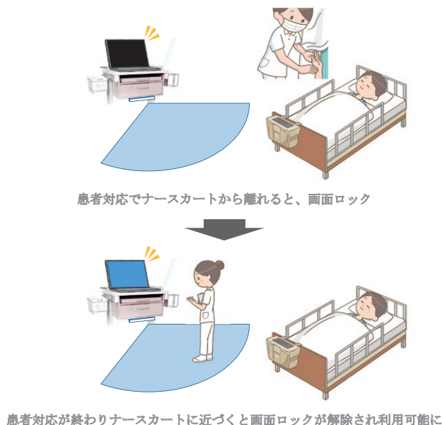
図2 測距センサによる画面制御
