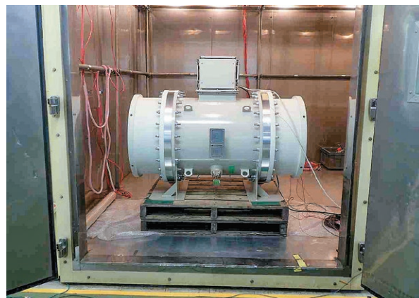
図 9 VT 温度特性試験状況
