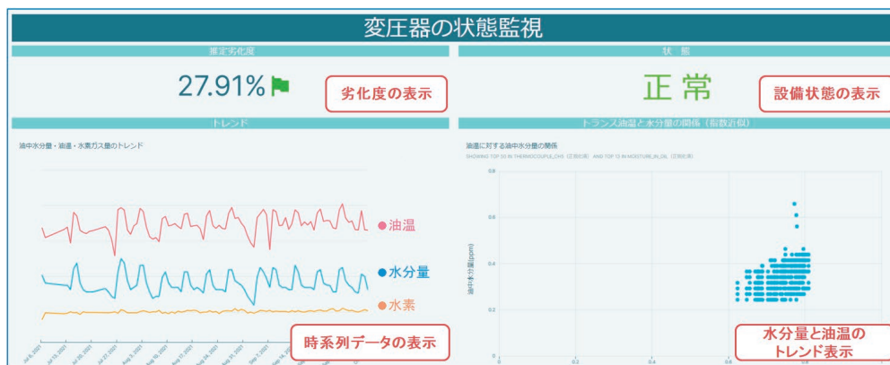
図2 変圧器の状態監視画面イメージ
