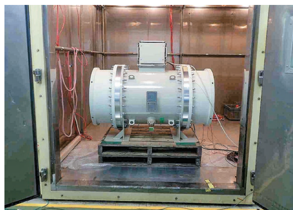
図 9 VT 温度特性試験状況
