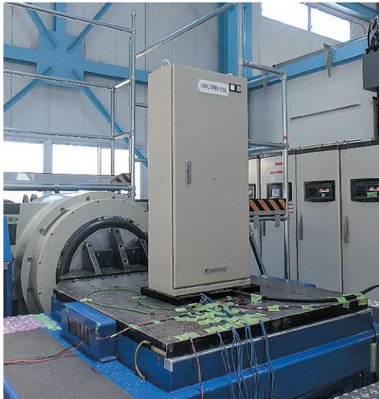
図7 振動試験風景
