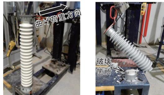
(a) 曲げ破壊荷重試験
