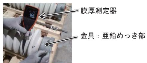
図8 亜鉛めっき試験
