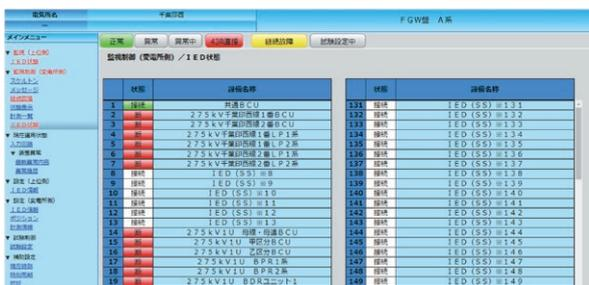
図3 HMI 対向BCU・IEDの監視画面
