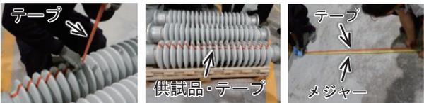
図3 表面漏れ距離試験
