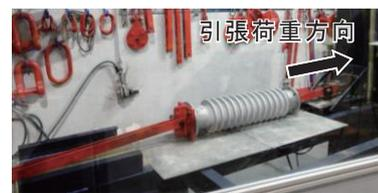
(b) 引張破壊荷重試験
