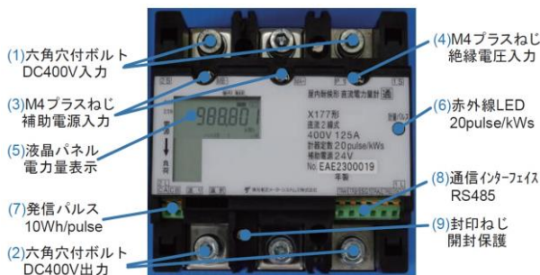
図1 各部の構造及び機能
