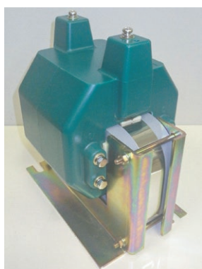
図 3 植物油由来エポキシ樹脂による実器試作品
