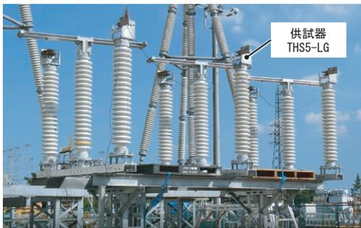
図 5 連続開閉試験状況 開放状態
