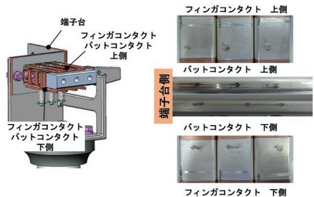
図 8 短時間耐電流試験結果 コンタクト表面状態
