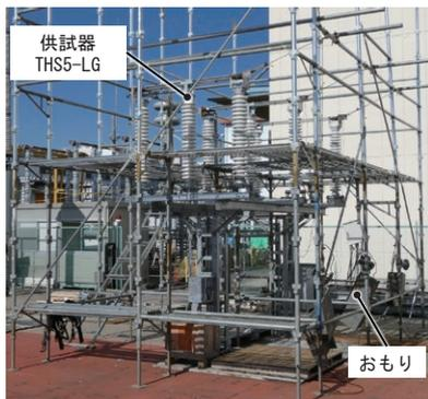
図 6 端子荷重試験状況
