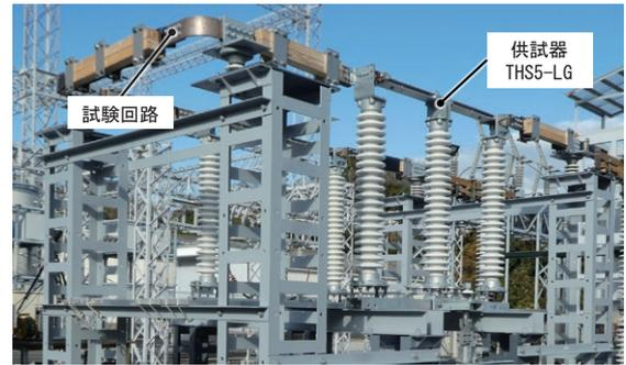
図 7 短時間耐電流試験状況（2相で実施）
