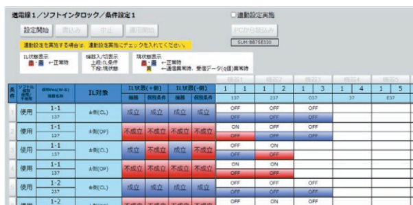
図6 HMIソフトインタロック画面
