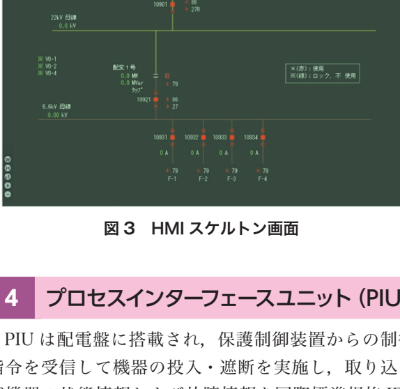
図 3 HMI スケルトン画面
