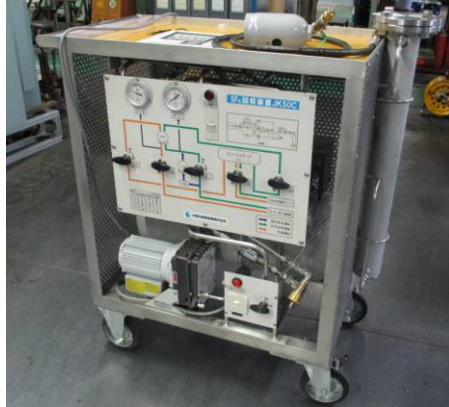
＜蓮田地区に新たに導入したS F 6 ガス回収装置＞
